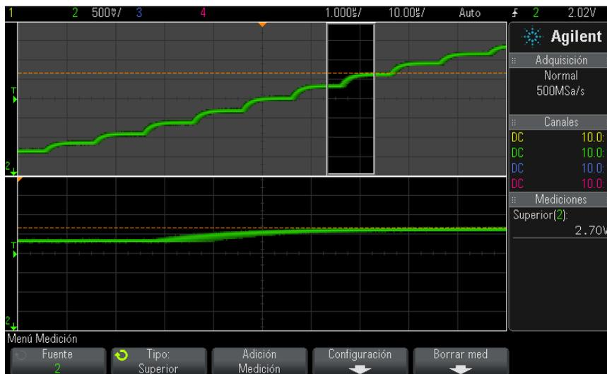
**Imagen 33** Aislamiento de un área para medición Superior
