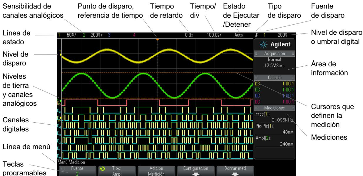
Imagen 1 Interpretación de la pantalla del osciloscopio
